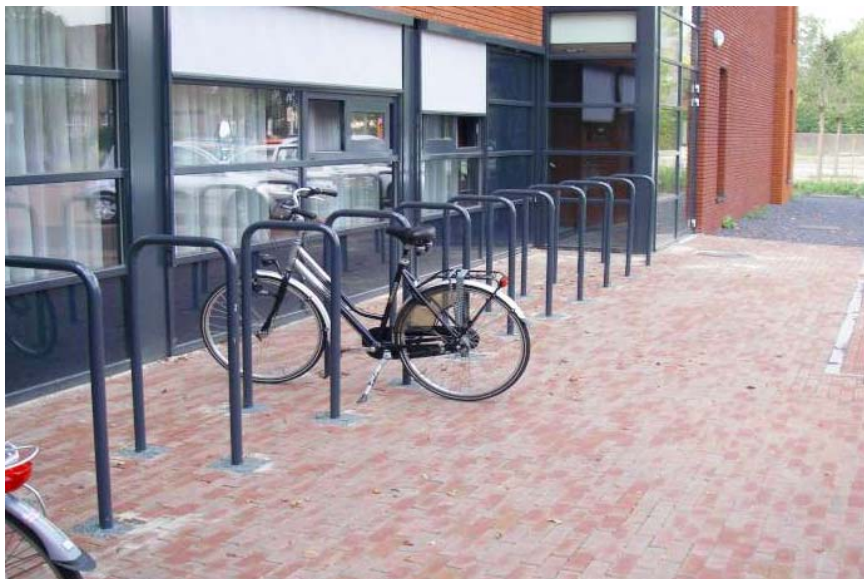
Figuur 3.3: Voorbeeld uitvoering fietsparkeerplaats 'nietje' (bron: www.grijzen.nl)
