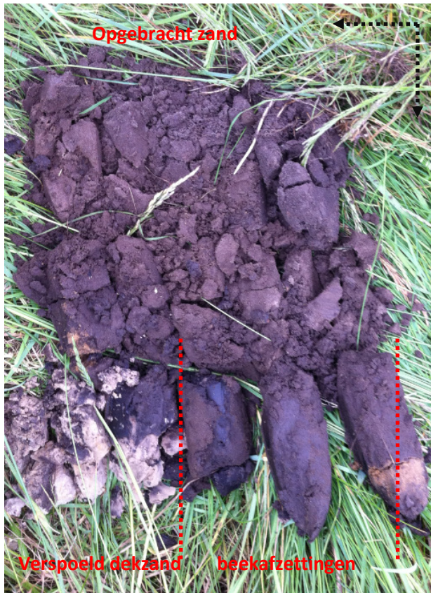
Opname van boring 2. Beekafzettingen onder een ophoogdek, uitgelegd per 50 cm
