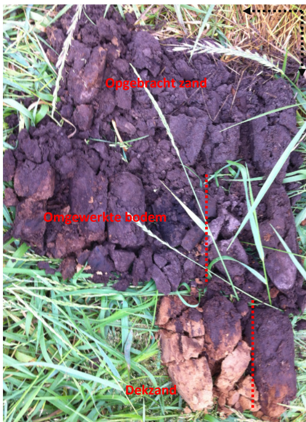
Opname van boring 4. Verstoord dekzand onder een ophoogdek, uitgelegd per 50 cm
