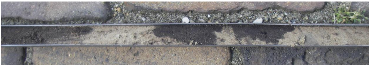
Figuur 15: Foto van de vergraven menglaag die in alle boringen boven de C-horizont is aangetroffen.
