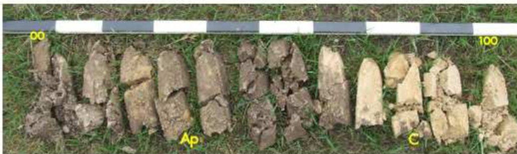
Figuur 8: Profiel van boring 1
