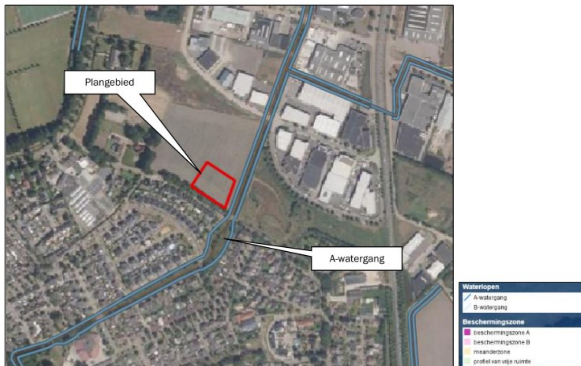
Figuur 23: Ligging leggerwatergangen ( https://maps.aanenmaas.nl/portaal/legger_oppervlaktewater/ ) (plangebied rood omkaderd)
