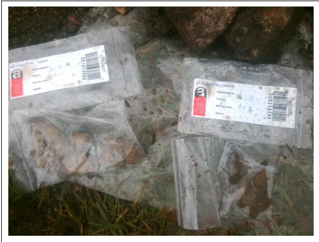
Foto 15. Asbestverdacht materiaal asbestinspectiegat B02
