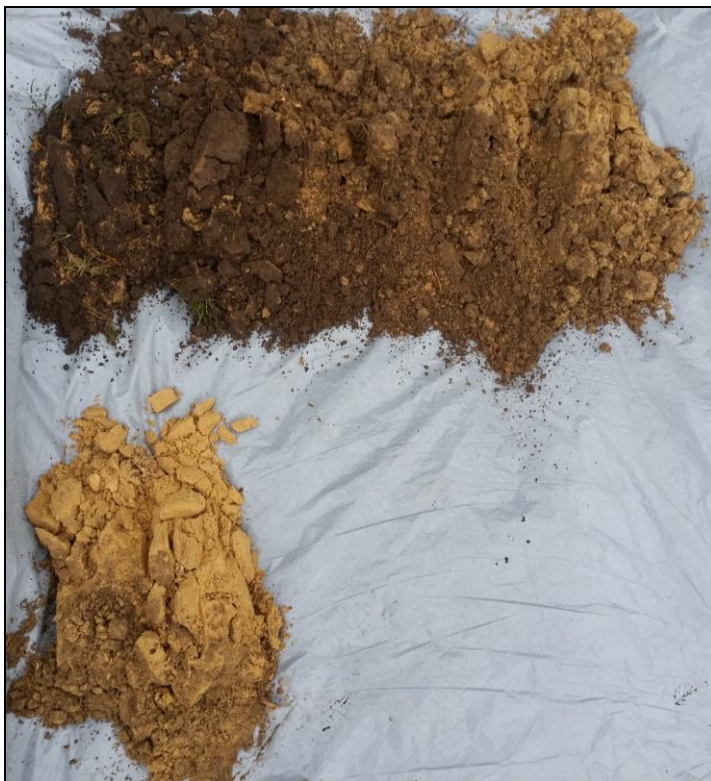
Figuur 7: boorkern van boring 3 uitgelegd van linksboven naar rechtsonder (0-70 cm -mv).
