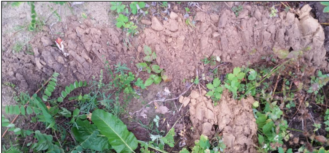
Figuur 6: boorkern van boring 7 uitgelegd van linksboven naar rechtsonder (0-130 cm -mv).
