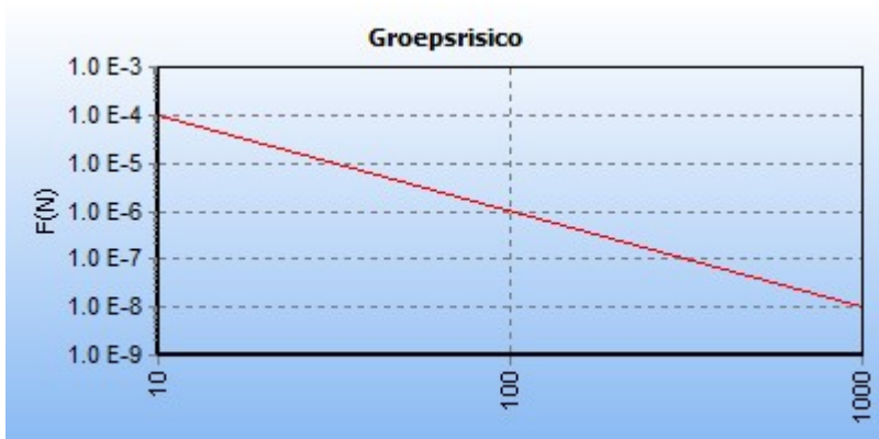
Figuur 4.6 FN curve voor 2710_leiding-Z-542-08-deel-1 van N.V. Nederlandse Gasunie voor de kilometer tussen stationing 720.00 en stationing 1720.00
