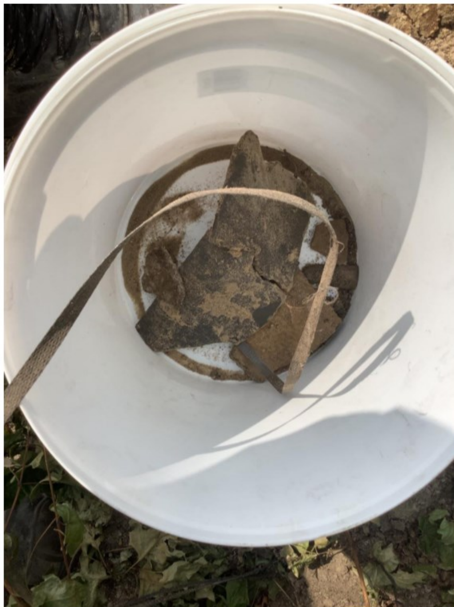
Figuur 41: Asbestplaten sleuf 41
