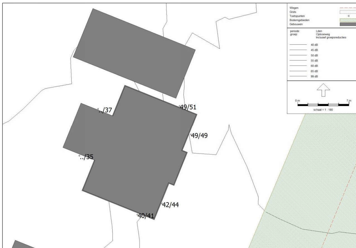
Afbeelding 4.2.2. Geluidbelastingen L_{den} [dB] op de beschouwde beoordelingshoogten ten gevolge van de Oploseweg.
