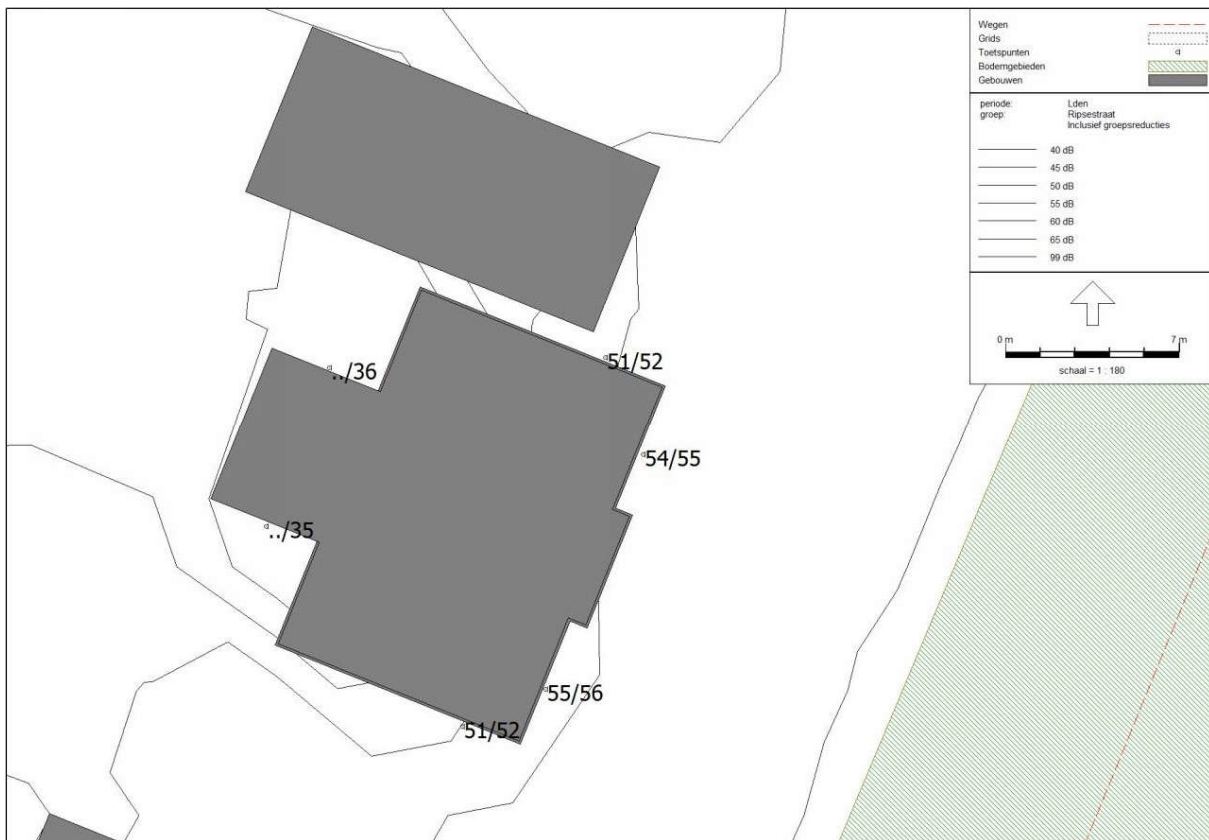
Afbeelding 4.1.2. Geluidbelastingen L_{den} [dB] op de beschouwde beoordelingshoogten ten gevolge van de Ripsestraat.
