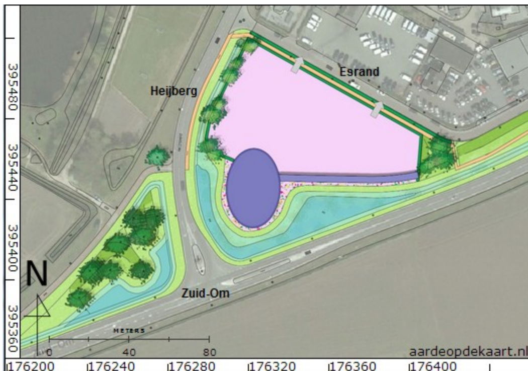
Figuur 2: Ontwerptekening van het plangebied. Legenda: Paars is de nieuwe bebouwing en roze wordt de nieuwe parkeerplaatsen.
