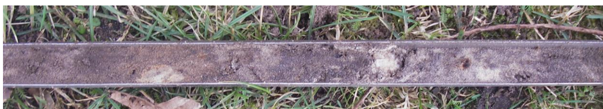
Figuur 15: Foto van boring 4 met daarin de sterk verstoorde toplaag zoals deze bovenin alle boringen is aangetroffen.
