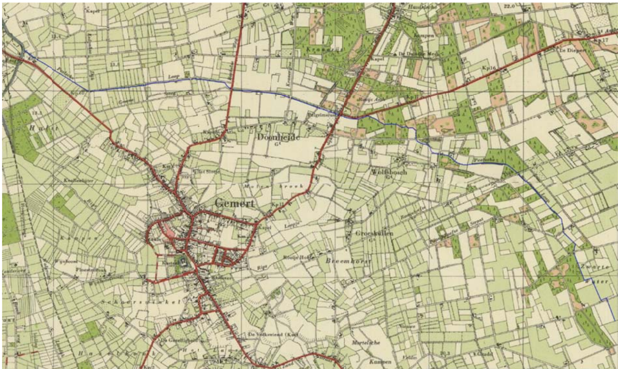
Figuur 3.2.2b. Kadastrale kaart 1930 (de Peelse Loop is blauw ingekleurd). Het Zwarte Water is drooggelegd door aanvulling met zand. In 1959 is een vijzelgemaaltje geplaatst op de overgang van het voormalige Zwarte Water en de Peelse Loop. In 1951 was al een stuwtje geplaatst in de Peelse Loop waar deze de Rooijenhoefse Dijk kruist om water beter vast te kunnen houden in tijden van droogte.
