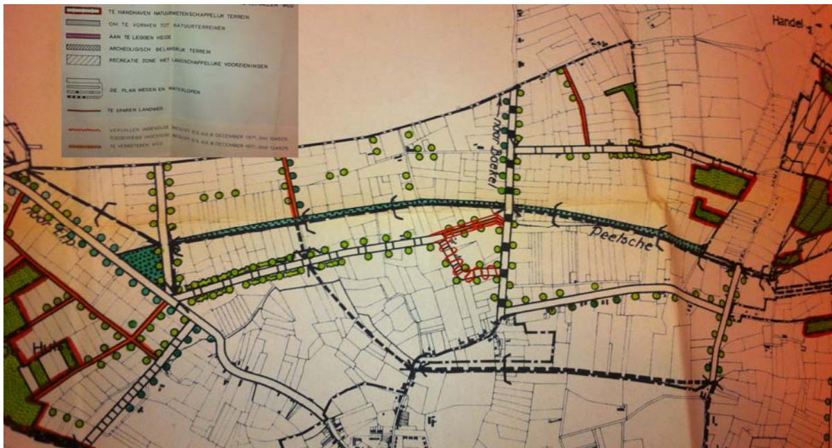
Figuur 3.2.3a. Kaart (1971) uit het dossier van de Ruilverkaveling Bakel met het nieuwe ontwerp van de Peelse Loop, waarin een groot aantal stuwen is geprojecteerd.
