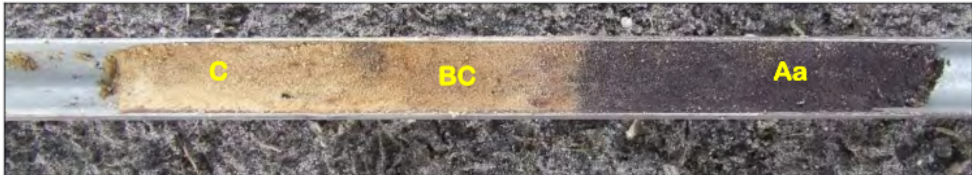
Figuur 32: Boring 81 met de scherpe overgang van de Aa-horizont (oud bouwlanddek) naar de BC-horizont van de oorspronkelijke veldpodzol
