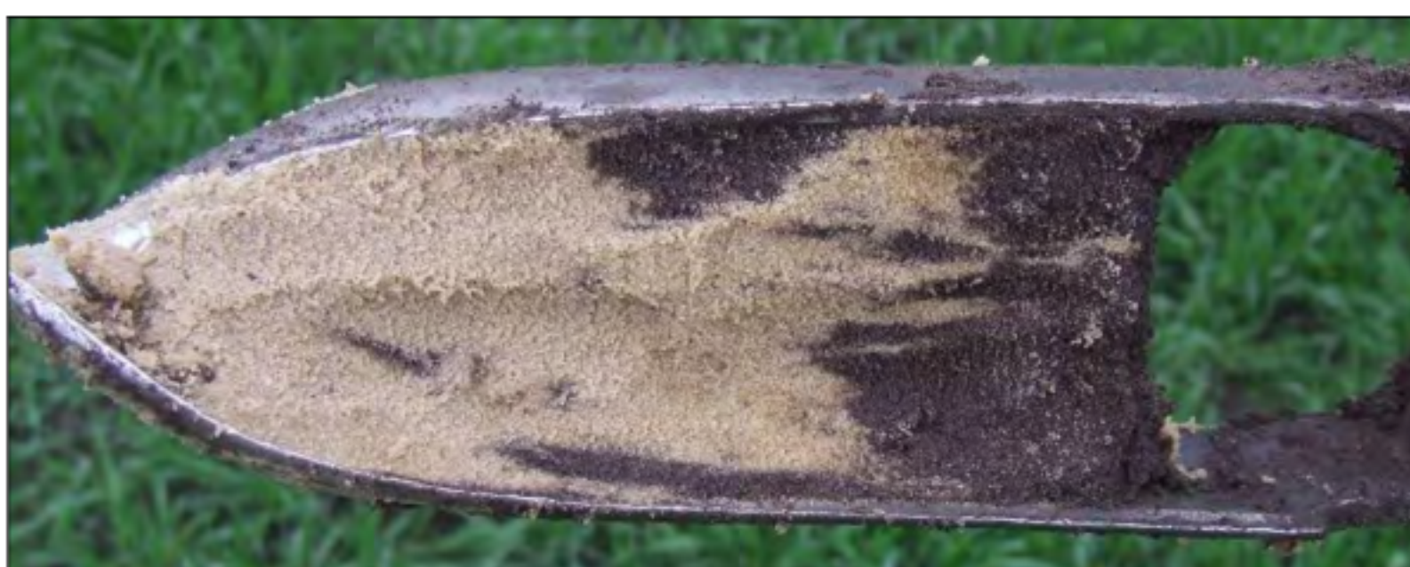
Figuur 12: Referentieboring 50 met de zwak geroerde overgang tussen de Donkere Aa- en de lichte C-horizont.
