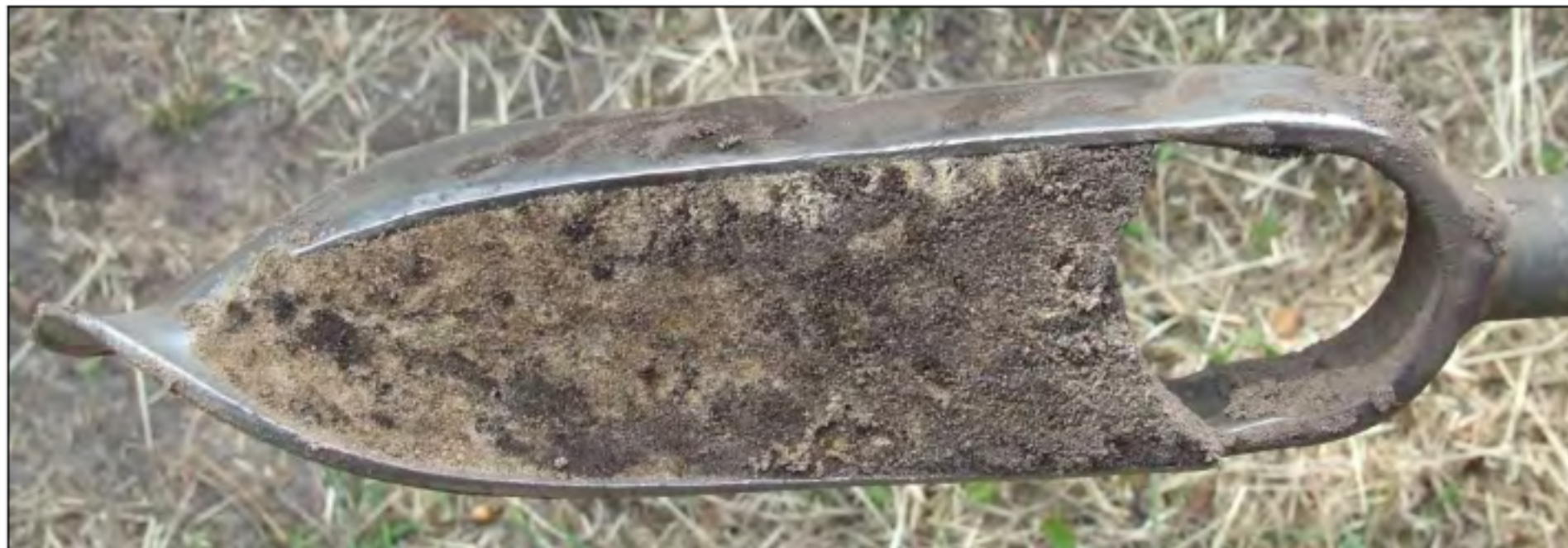
Figuur 63: Boring 203 met een deel van de sterk verstoorde A/C-horizont tussen 40 en 140 cm -mv
