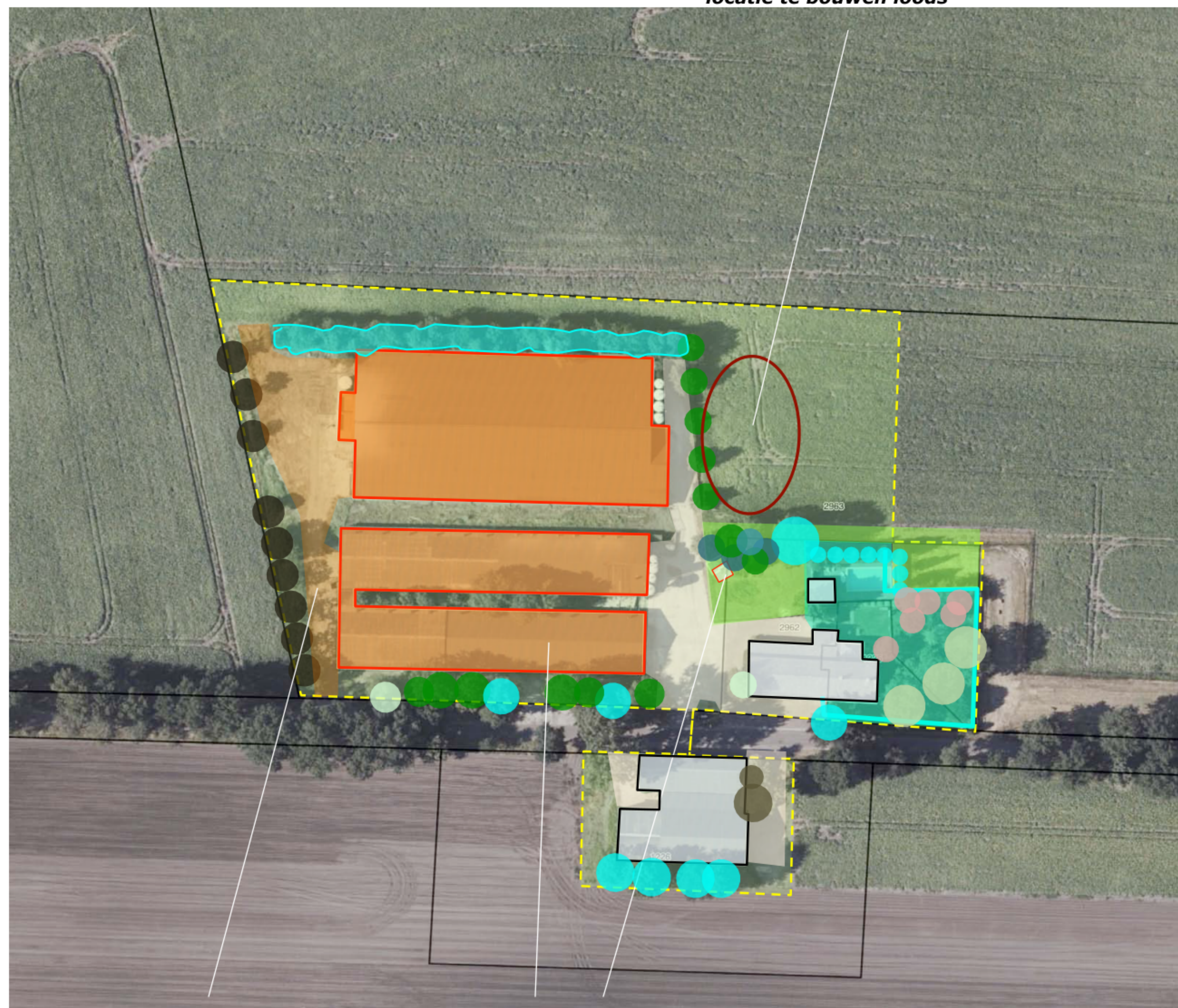
te verwijderen verhardingen en te slopen gebouwen
