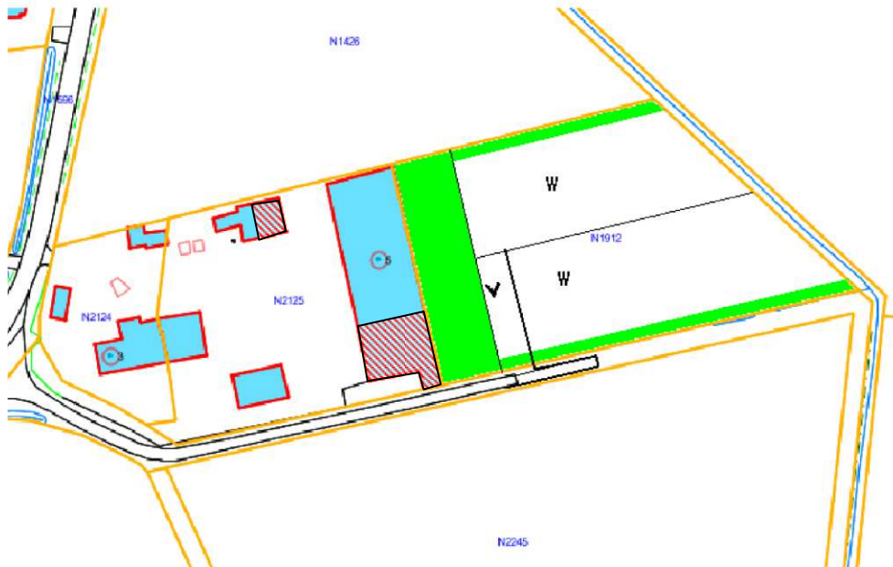
Figuur 3: Toekomstige indeling plangebied. De gearceerde delen zijn de indicatief te slopen delen van de aanwezige bijgebouwen.
