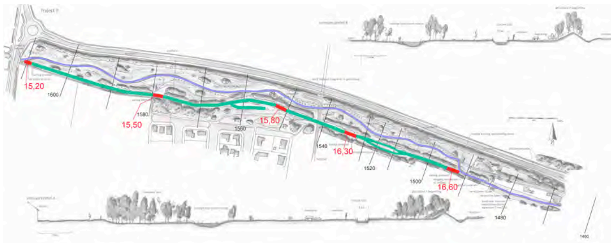
Figuur 4.22. In rood de locaties van de drempels met hoogtes in de oude bedding (groenblauw). Ernaast ligt de nieuwe vrij afstromende bedding (blauw).
