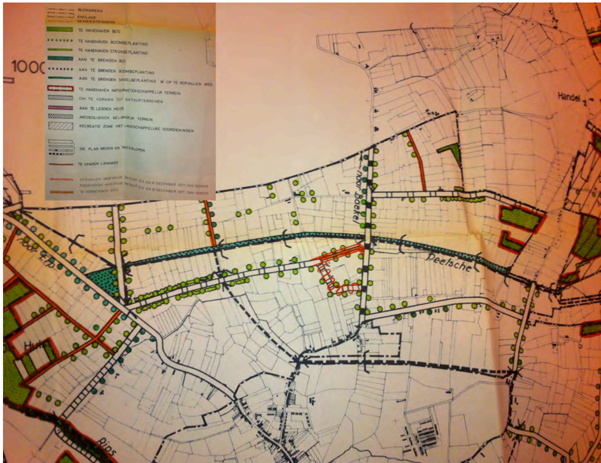
Figuur 3.8. Kaart (1971) uit het dossier van de Ruilverkaveling Bakel met het nieuwe ontwerp van de Peelse Loop, waarin een groot aantal stuwen is geprojecteerd.
