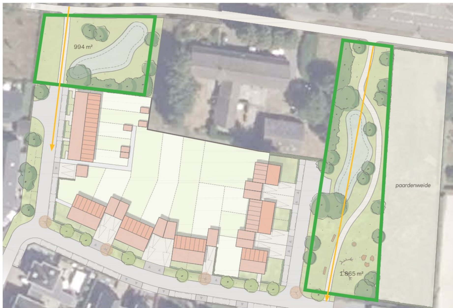
Groenvoorzieningen met hemelwaterbergvoorzieningen
