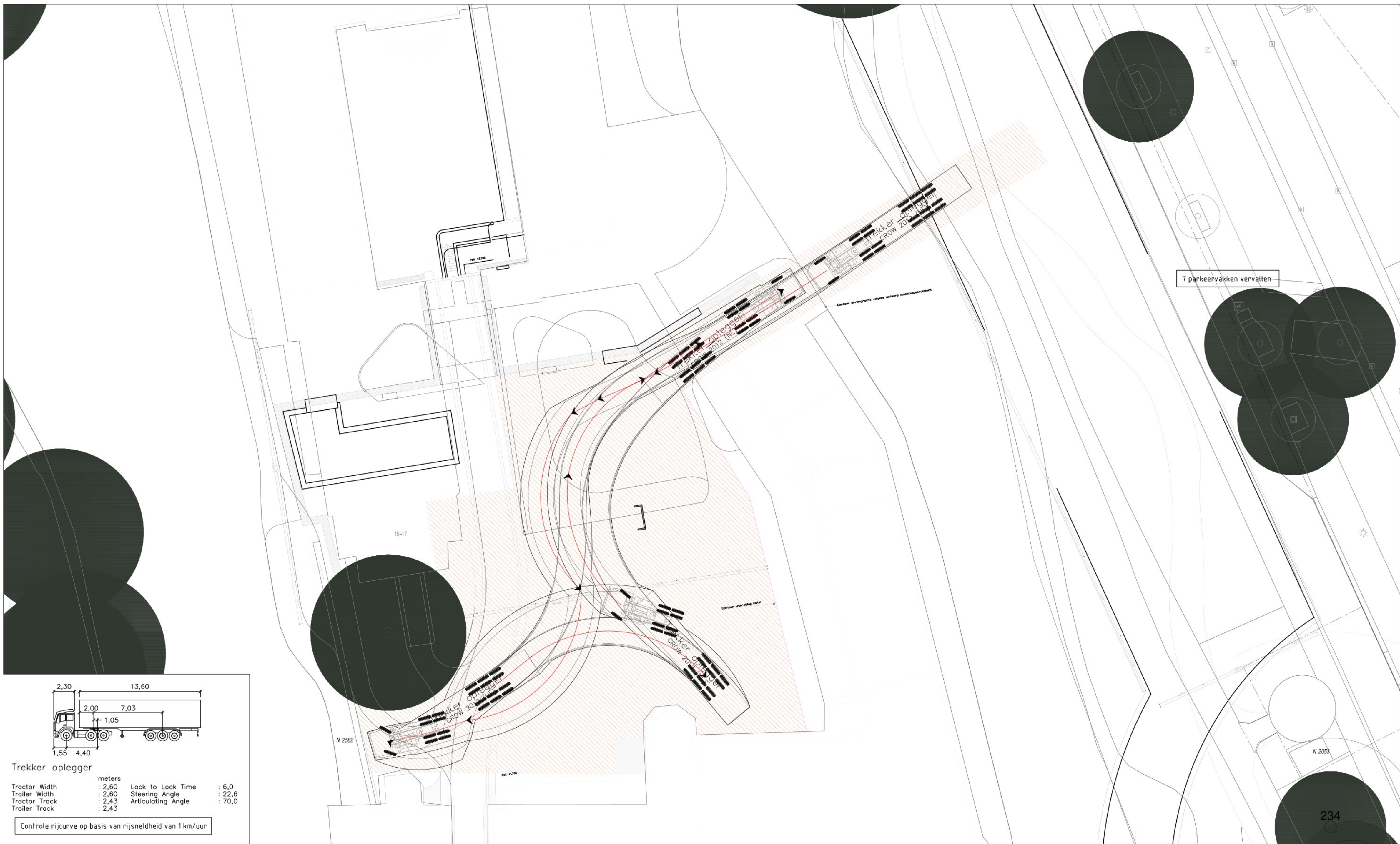
Rijcurve Trekker oplegger
